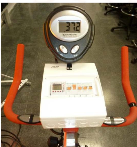
Figura 4: Vista del manillar con los sensores de pulso, los interruptores de las cargas, el analizador de redes y la pantalla original de la bicicleta estática
