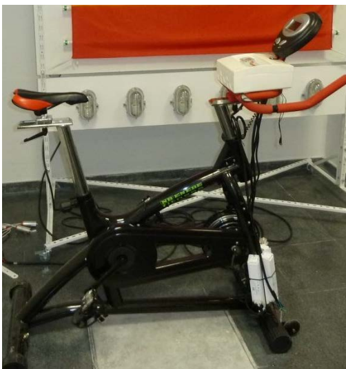
Figura 3: Bicicleta estática después de sustituir el volante de inercia por el motor de rueda trasera de bicicleta.
